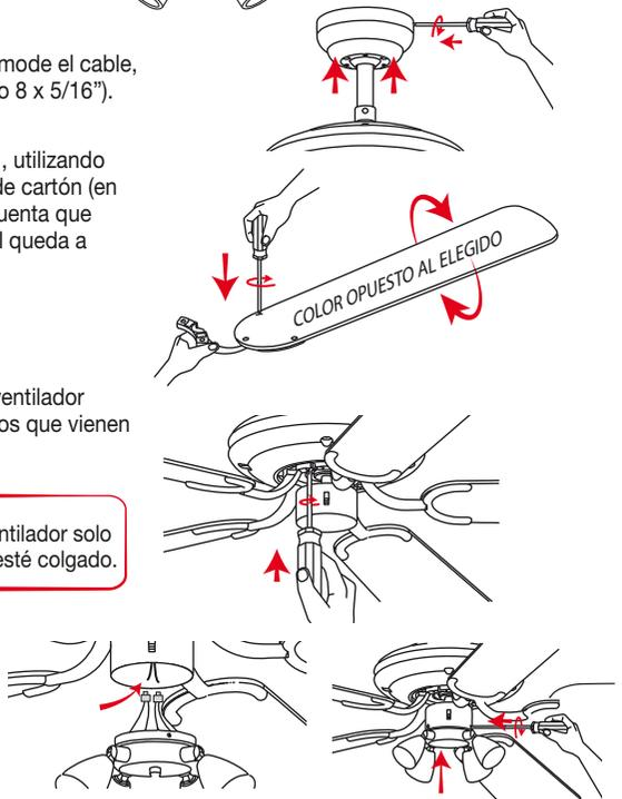
11 Coloque las cuatro tulipas enroscándose en la luminaria utilizando el kit de fijación provisto (11.1) del modo que se muestra en la imagen.
